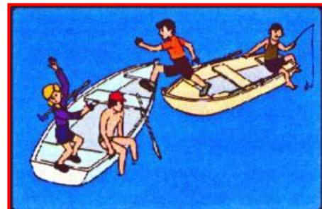
2. Производить посадку в лодку следует по одному человеку, ступая на середину настила лодки, равномерно рассаживаясь на сиденья относительно бортов. Нельзя перегружать лодку.
